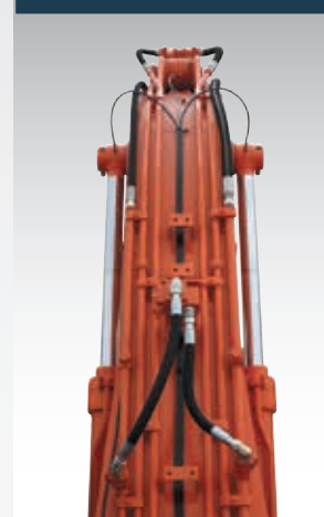
4. HSB破碎锤/破碎装置共用配管
