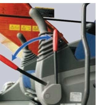
如果不完全锁定锁杆，就无法启动发动机。避免了操纵杆的意外动作。
