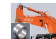
②斗杆/铲斗连接部分的接触面采用WC溶射
