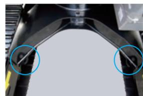
在行走架下方的法兰上，前后共设置了4个运输时用来固定机器的孔。
