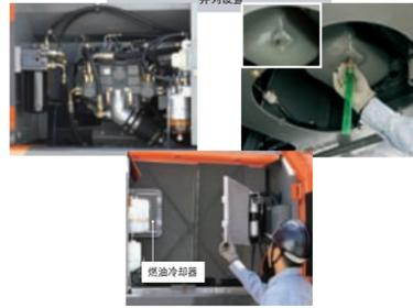
并列设置液压油冷却器、散热器、中冷器
