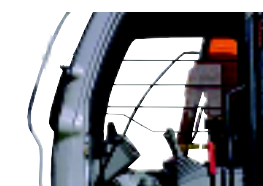
驾驶室右侧防护栏
