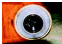
WC 溶射处理 - ZAXIS200: 无伤痕 (1,000 小时未加油)
