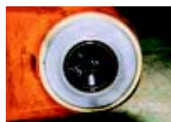
WC 溶射处理 - ZAXIS210LC: 无伤痕 (1,000 小时未加油)
