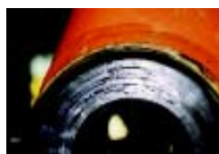
未做 WC 溶射 - EX210LC-5: 有伤痕 (300 小时未加油)
