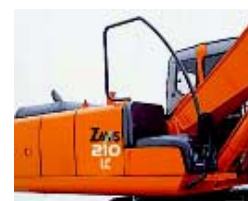
符合 ISO 要求的大型扶手和踏板
