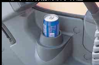
■带冷、热功能的饮水杯座
